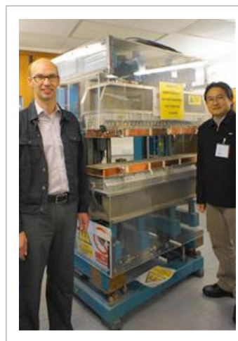
รูปที่ 6 แสดงรูป 2.4 เทสลา Hybrid wiggler จาก Darebury Laboratory ประเทศอังกฤษ
